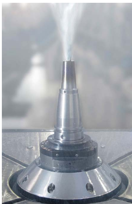
Доставка СОЖ к вершине инструмента при 18 000 об/мин. Coolant to the top of the cutting tool @ 18,000 rpm.
